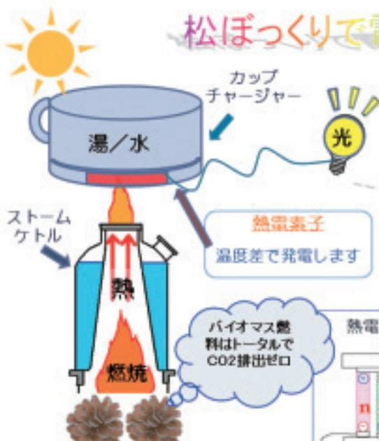
電気を流す物質の片方を温めると、電子が活発に動き出し温度の低い方へと移動・拡散する。すると均一だった電子の数が、温度の高い方が少なく、温度が低い方が多くなり、プラス極とマイナス極ができて電圧が発生します。この原理(ゼーベック効果)を生かして、松ぼっくりから電気をつくります。
