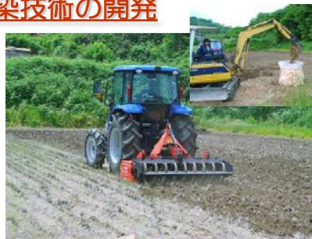
表層土剥離のための農業用機械の開発と土壌の処理方法の確立による汚染低減
