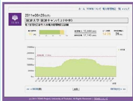
学内の使用電力をリアルタイムに把握する本学独自の電力情報システム「TEMS」を構築し、つくばキャンパス内の建物群ごとの使用電力状況をウェブ上で教職員・学生が参照できるようにしました。グラフだけでなく、地図上からも電力使用状況を確認できます。
