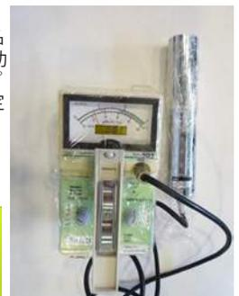
放射線計測に使用した機器（γシンチレーションサーベイメータ）
