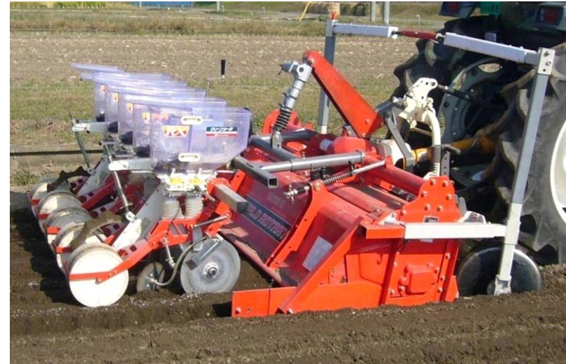
小明渠浅耕播種機によるナタネ播種作業
