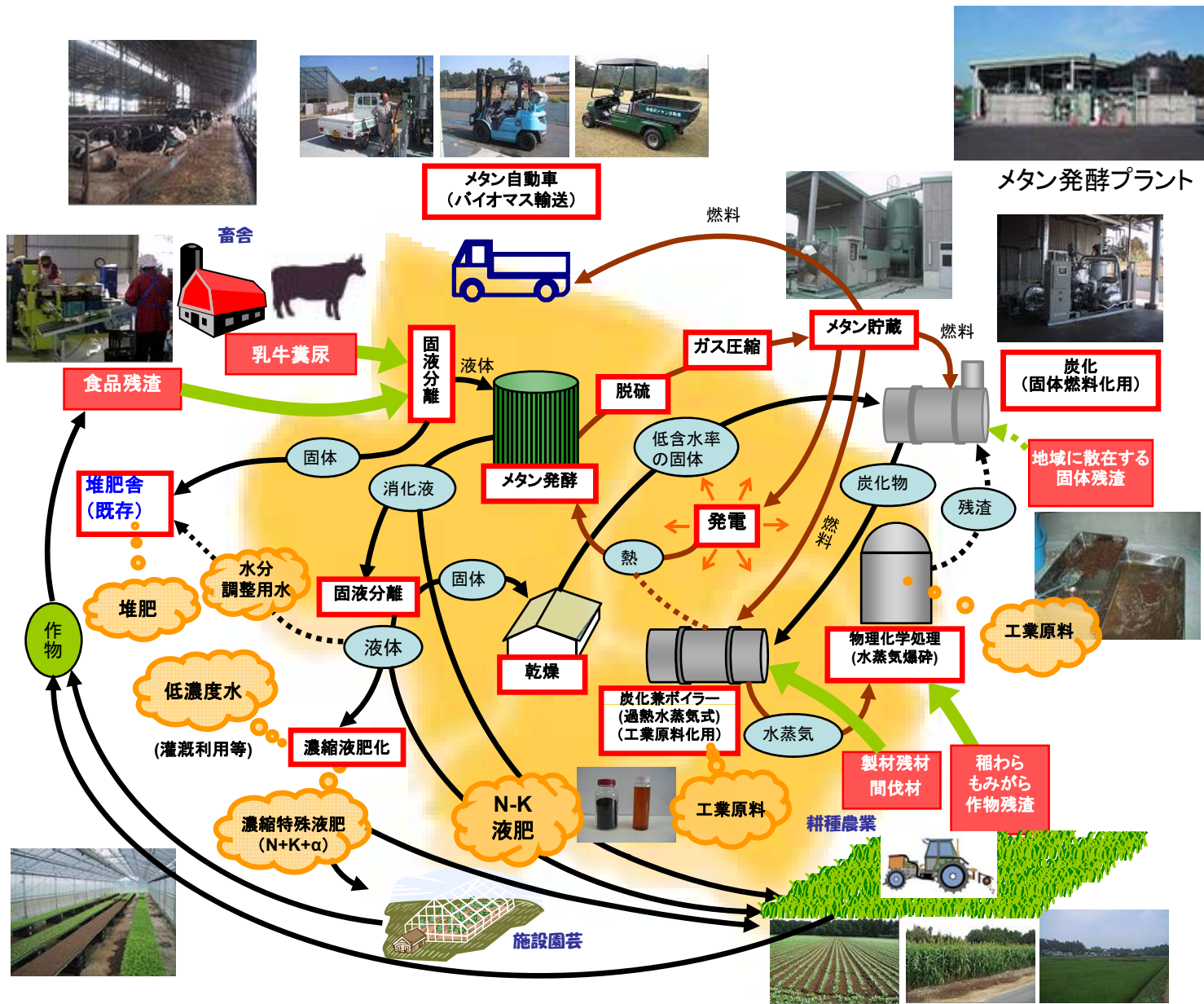
山田バイオマスプラントを核とするバイオマス多段階利用システム(2008年版)
