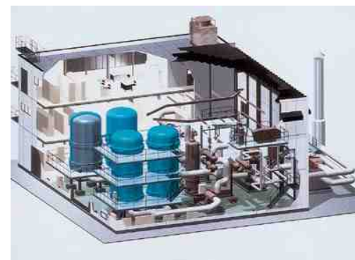
熔融炭酸塩形 1,000kWパイロットプラント 中部電力川越火力発電所内
