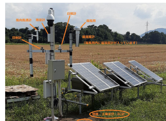
【画像3】遠隔監視システム（①農場のリアルタイム画像や②環境データ（温度、湿度、日照など）の取得）
