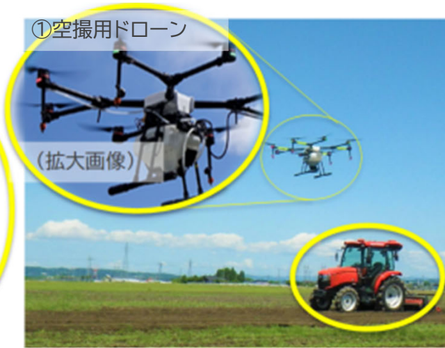
【画像2】ドローンによる生育診断とGPS自動操舵システムによる直進アシスト
